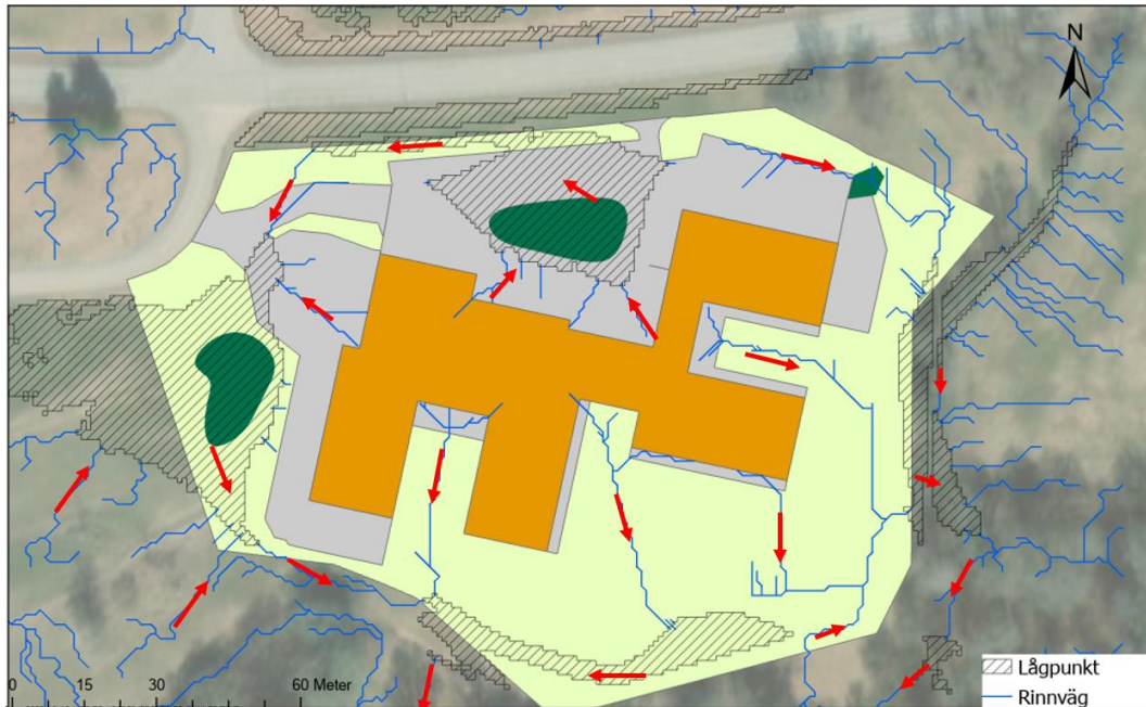
Figur 10. Rinnvägar på vårdboendetomten enligt höjdsättning från förstudie. Röda pilar markerar flödesriktningen.
