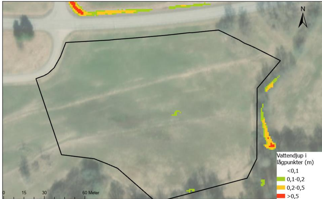
Figur 5. Vattendjup i lågpunkter för befintliga höjder på vårdboendetomten.
