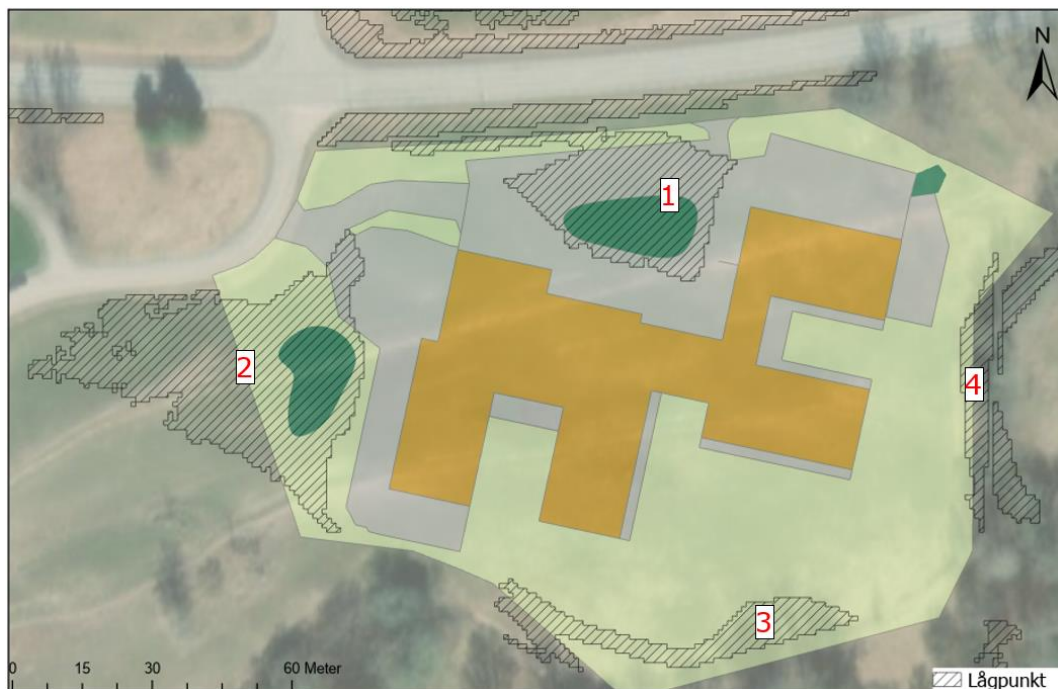
Figur 8. Identifierade lågpunkter inom vårdboendetomten utifrån höjdsättning från förstudie. Mörkgröna ytor markerar ytor utpekade för fördröjning, jämför Figur 8. Nummer motsvarar lågpunkterna i Tabell 3.
