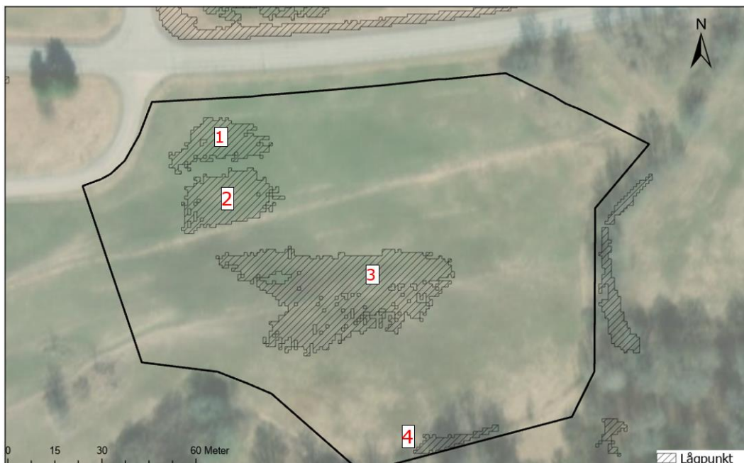
Figur 4. Identifierade lågpunkter inom vårdboendetomten utifrån befintliga höjder. Svart linje utgör ungefärlig utbredning för vårdboendetomten. Nummer motsvarar lågpunkterna i Tabell 2.
