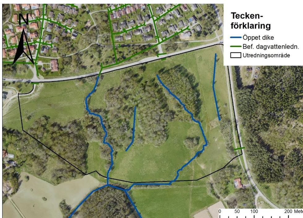
Figur 6. Befintligt dagvattensystem i närområdet till utredningsområdet.
