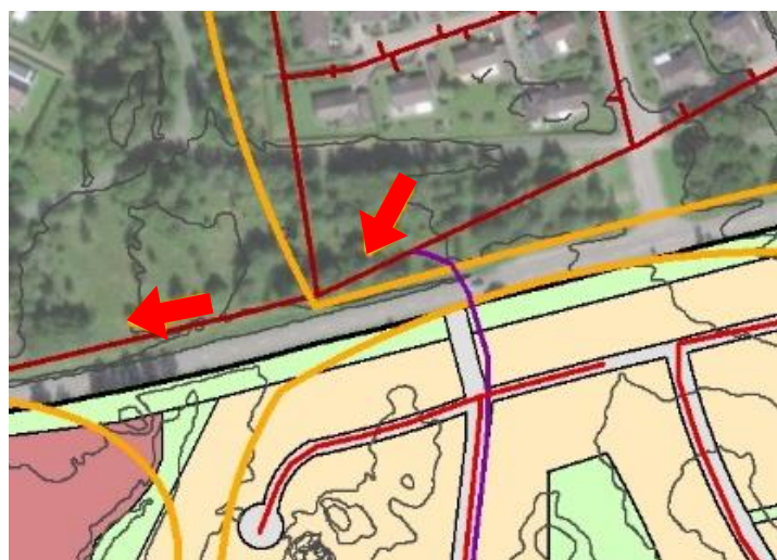
Figur 22. Anslutning av tryckledning (cerisemarkerad) till befintlig 300 BTG-ledning.
