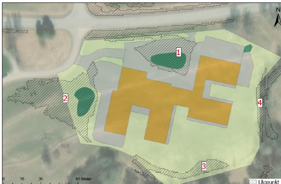
Bilden visar befintliga lågpunkter inom vårdboendetomten med höjdsättning enligt förstudien. Gröna ytor är utpekade som fördröjningsytor. (AFRY)
