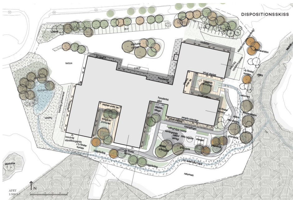
Illustration som visar hur dagvattnet föreslås att anläggas på vårdboendetomten (AFRY).
