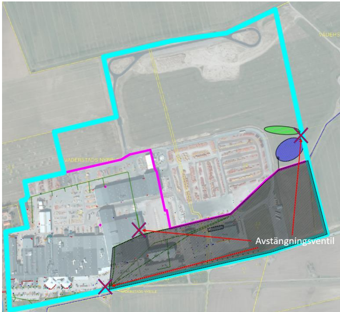
Figur 13. Placering av avstängningsventiler i dagvattensystemet. Skrafferad yta är område som bedöms svårt att omhänderta släckvatten från.
