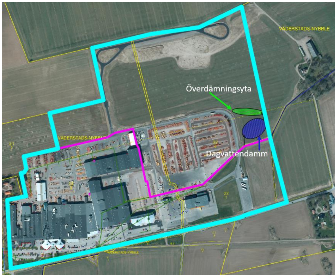
Figur 12: Skiss över dagvattenanläggningar på det nya området.
