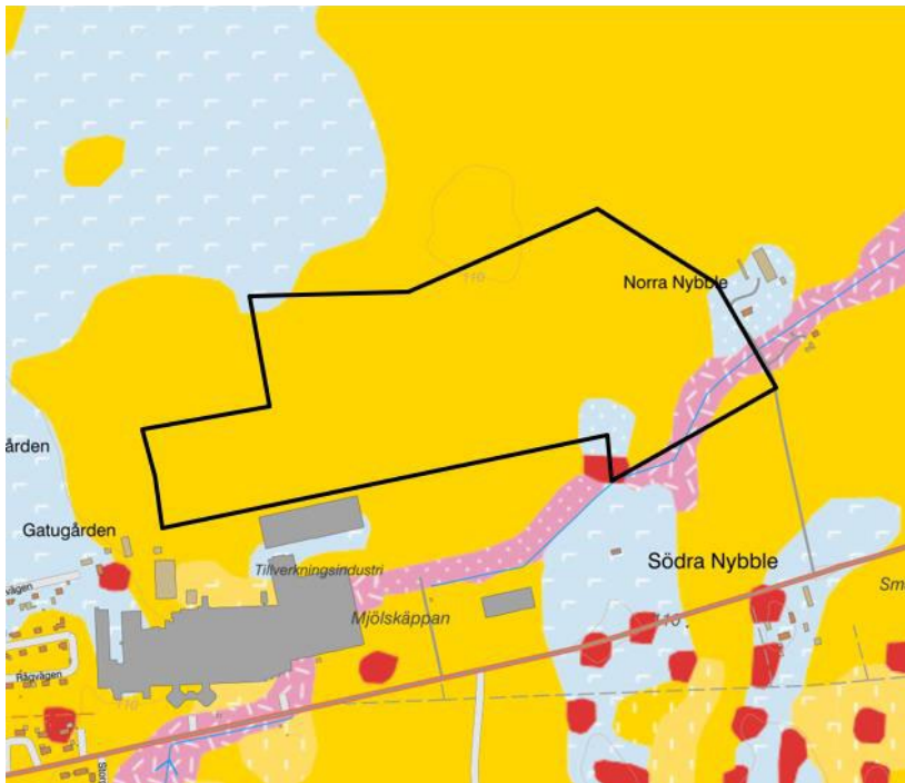
Utbredning av utredningsområde för genomförd geoteknisk undersökning markerad med svart på SGU:s jordartskarta. Källa: SGU
