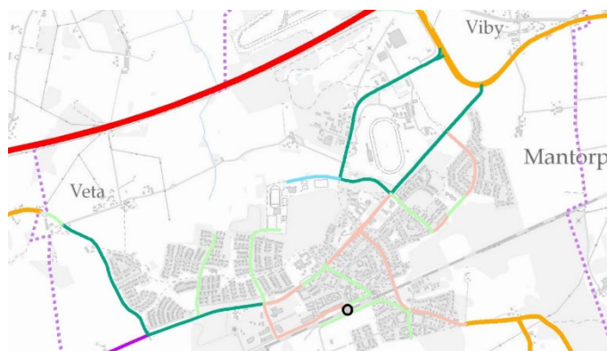
Figur 36: Befintligt huvudgatunät, med skyltad hastighet: Ljusgrönt 30 km/h, Rosa 40 km/h, Ljusblått 50 km/h, Mörkgrönt 60 km/h, Orange 70 km/h, Lila 80 km/h.
